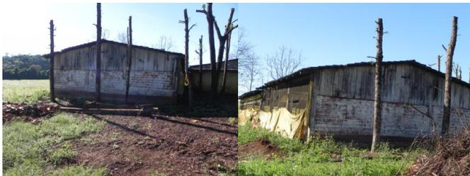
Uma pocilga mista, de alvenaria e madeira, coberta com 50% cimento amianto e 50% telhas de barro, piso de concreto, fechada com tela e lona, medindo 200 m<sup>2</sup>, em regular estado de conservação.
